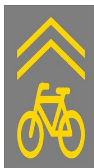
20. ábra - Kerékpáros nyom útburkolati jel
